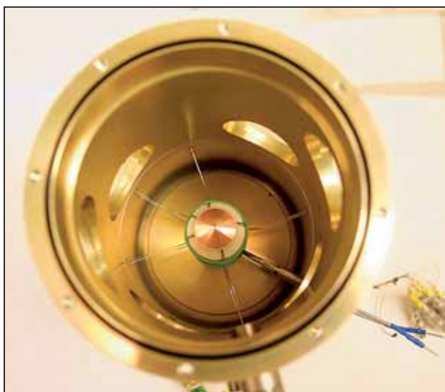
Die Testzelle: Auf die Mitte wird Flüssigkeitsspray gesprüht.
